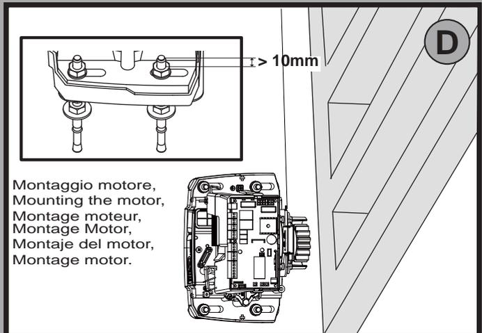
**Montaggio motore, Mounting the motor,
