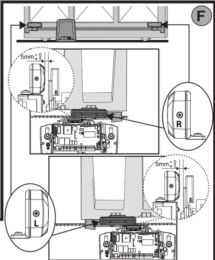
**Fissaggio staffe finecorsa (dx e sx), Fastening limit switch brackets (RH/LH)
