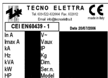
La targhetta tecnica viene fissata sulla parte esterna del quadro elettrico, ne riporta le principali caratteristiche e ne attesta la conformità alla direttiva macchine 89/392 CEE (allegato B), pertanto ne è valida la sua marcatura CE solamente montata con macchine che siano costruite in accordo alle disposizioni della direttiva macchine 89/392 CEE e successivi aggiornamenti introdotti 91/368 CEE, 93/44 CEE, 93/68 CEE.
